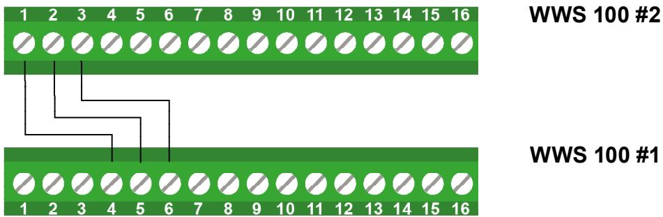
Der WWS 100-Sensor ist an der Steuerung an 5X oder 6X angeschlossen (Der Eingang für die RWA-Bedienstelle oder die Master-Slave-Verbindung).
