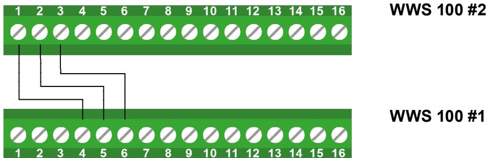
Le Capteur WWS 100 est raccordé au 5X ou 6X sur le panneau de ventilation de fumée (l'entrée pour l'unité de bris de glace ou au Master-Slave).
