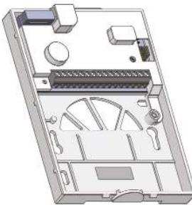
Öffnen Sie den Kasten unten und entfernen Sie die vordere Abdeckung! Entfernen Sie das Flachbandkabel!
